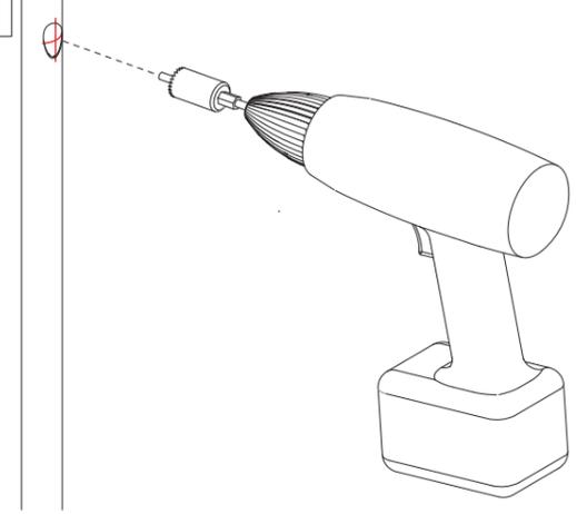
For  $\phi 25\text{mm}$  (1") tube:  $\phi 20\text{mm}$  (25/32") hole saw
